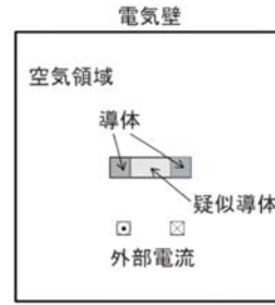
図1. 2次元渦電流場解析モデル (提案手法の評価実験用)
