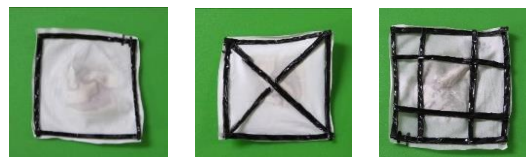
図-4. 両面導電テープの貼り方比較 (左から、四辺、クロス、格子型)
