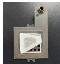
図-3. 卵殻膜と電極の両面テープ固定
