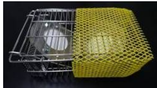
写真 1 パッシブサンプラーの外観(サンプラーは落葉等の付着や石の衝突による破損を防止するためステンレスかごの中に設置する)
