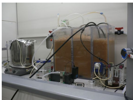
図 2. 膜分離型廃水処理装置(MBR)
