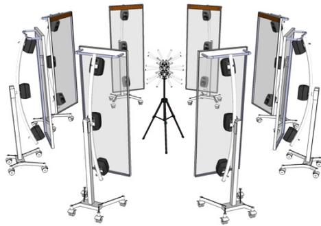
図 2: 鋭指向性マイクロホンアレイと 24 チャンネル再生システム
