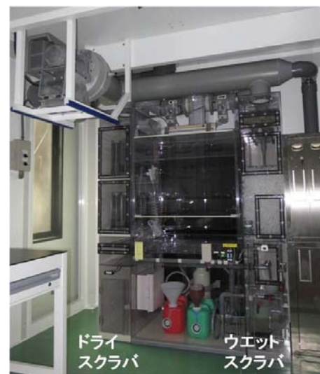
図 1. 化学物質取扱い者向けヒュームフード実習教材の(a) イメージ図と(b) 実際の教材
