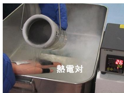
図 4. 液体窒素が保護手袋を装着した手にかかった際の温度変化測定手法
