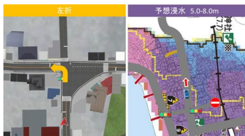
図 3 カーナビによる経路案内画面(左)とハザードマップの表示(右)の例
