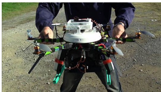
図 3 本研究で使用した UAV の外観 (上向き撮影用カメラジンバルの装着)
