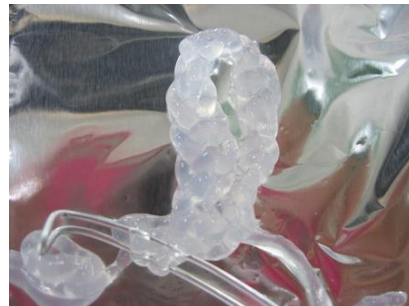
Fig.1 作製したゲルストランドを編織する様子
