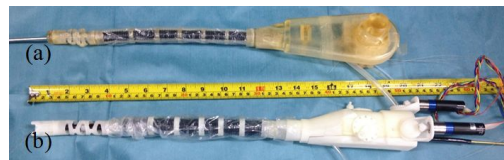
Fig.5 試作した柔剛可変外套管デバイス(a)手動式プロトタイプ(レーザは単方向)(b)先端部レーザ首振り機構付きデバイスプロトタイプ
