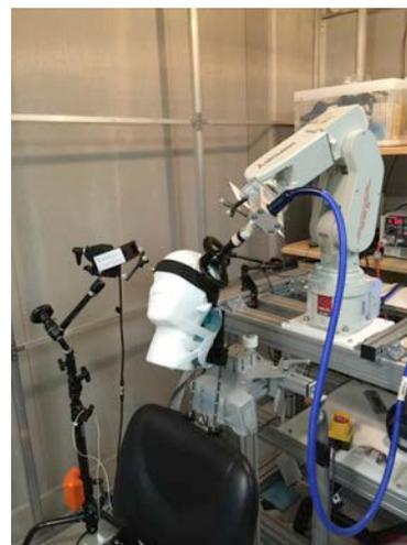
図2: 産業用ロボットアームを利用したTMSシステム。
