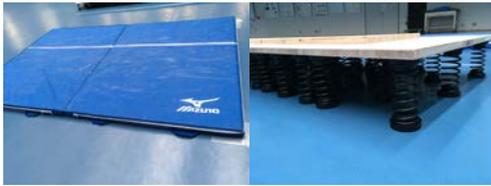
図4 仮設走路に用いたマット(左)と弾性体を配置した走路(断面)(右)
