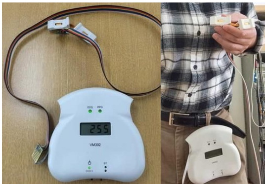
図5 試作セルフコントロール支援バイタル信号測定機器部(左)と装備形態(右)
