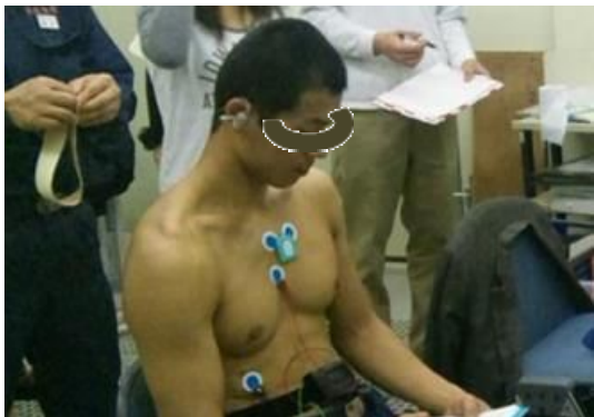
図6 試作バイタル信号測定デバイスと一般心電測定装置の並行装着(図では、鼻梁を隠さざるを得ないため、耳朶に半導体素子を貼付している。)
