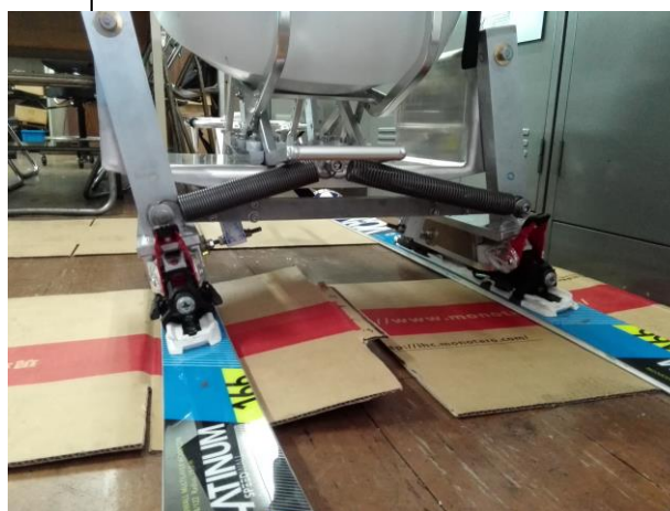
図7 バネによる重心回りトルク増強機構
