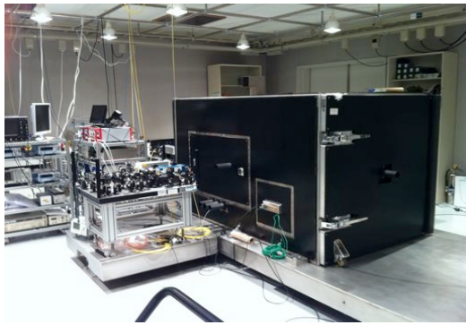
図2 OPAMを用いたMEG計測システムの外観. 磁気シールドボックス内には非磁性のベットが設置されている.
