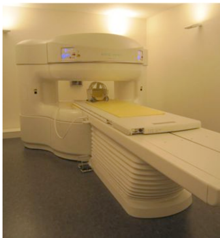
図3 実験に用いた永久磁石型0.3T-オープンMRI装置
