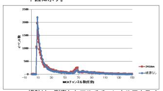
横軸は、測定したマルチチャンネルアナライザ(MCA)のチャンネル数であり任意の大きさである。シンチレータであるため、ガンマ線を多く検出していることが判る。このガンマ
