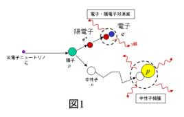
型(0.3m³ 程度)の原子炉ニュートリノ検出器を開発する。この測定器はニュートリノの方向に感度をもち、中性子の飛行時間を用いてニュートリノのエネルギーを測定する。小型の検出器を製作し、原子炉の超近傍でニュートリノの検出を行うことにより測定原理の実証を行うことを目的とする。
