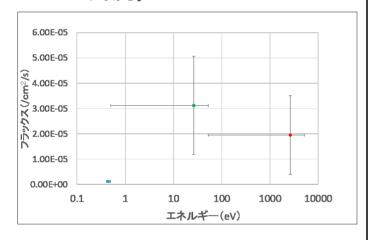
(3) <sup>6</sup>Li 検出器の性能評価。 <sup>6</sup>Li 検出器によって、<sup>241</sup>Am で発生する中性子を観測した結果を 下図に示す。
