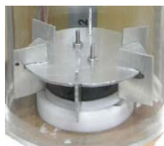
図2. 超流動ヘリウムの回転流駆動装置
