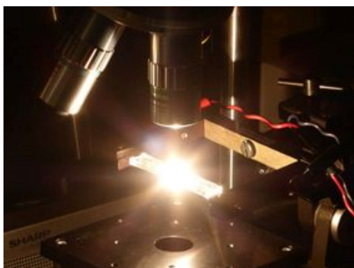
図．超焦点対物レンズ下に設置された光源を用いて熱放射温度計の校正が行われる。
