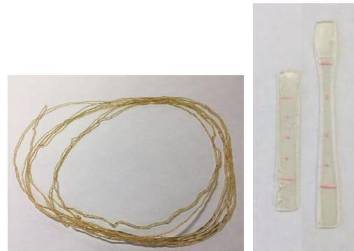
図 4 押出機で調製した ChNF 系ガット状複合体（左）と熱延伸フィルム（右）の外観
