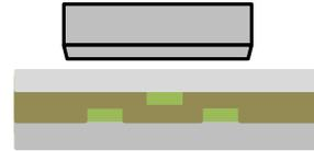
図3 シリカモールドに作製した十字コースアライメントマークとシリコン基板に作製した4つのL字アライメントマークの概要図。(a) 光硬化性蛍光組成物(NL-SK1F)を塗布し、(b) モールドと基板を密着させて反射光学観察と蛍光観察を行う模式図
