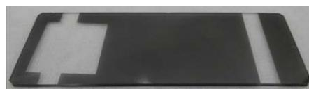
図3 Crを成膜した参照板
