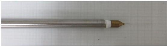
図3 圧力計測プローブ
