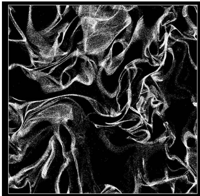
図1 乱流中の粒子群のクラスタ(粒子を質点として扱った数値シミュレーション結果)。
