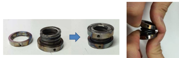
図1 バネ材の溶接による椎間板の造形
