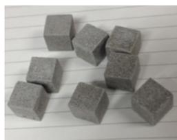
写真-4 静水圧による成形体の例
