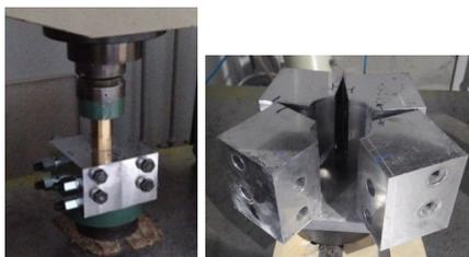
写真-1 一方方向荷重による成形で用いた型枠（左：成形中、右：分割の様子）
