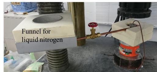
図-1 凍結供試体保温装置
