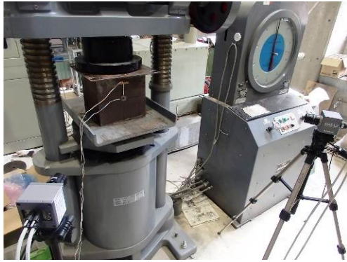
図4 三次元計測の検証
