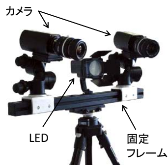
図2 既往の画像計測システムの計測部
