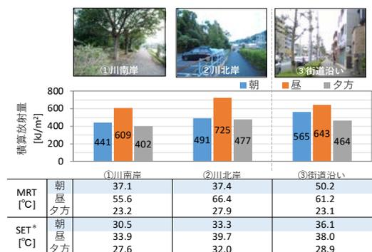
図3 経路別の積算での放射受照量の結果
