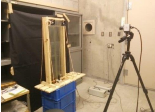
図 3 PIV 手法による H-AFW 内通気の可視化装置
