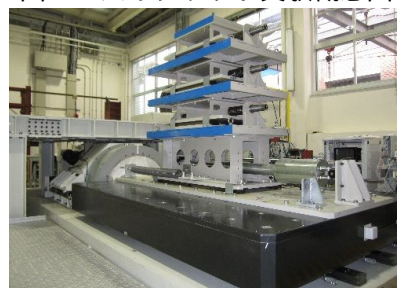
図 3 振動台によるリアルタイムハイブリッド実験
