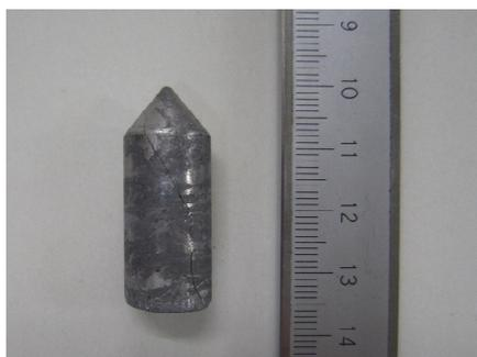
図4.ブリッジマン法により作製したMnAlGe化合物
