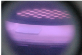
図 3. 局所集中プラズマレイによる a-C ナノ粒子作製装置
