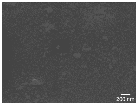
図 6. シリカ膜表面の走査型電子顕微鏡 (SEM) 像.
