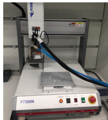
図 4. プラズマヘッド (上) および大気プラズマ CVD システムの写真 (下)
