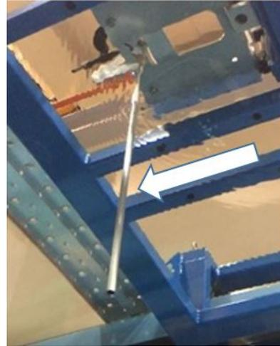
図 4 回流水槽を用いた VIV 実験
