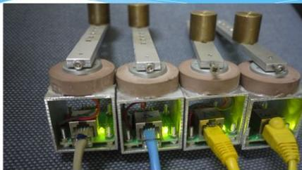
Fig.4 作成したフープ部分。ケースの中に発電装置と傾斜計を配置してある。
