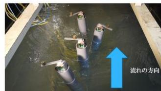
Fig.6 円柱列を回流水槽に配置し、計測を行う。流れの向きは図下から上
