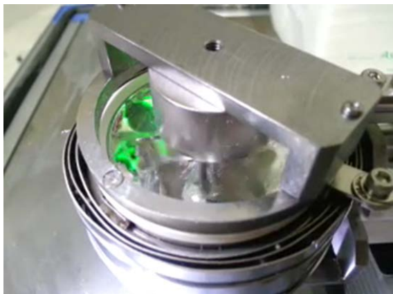
図-4 電磁力攪拌液体金属ダイバーター概念の原理検証実験セットアップ。
