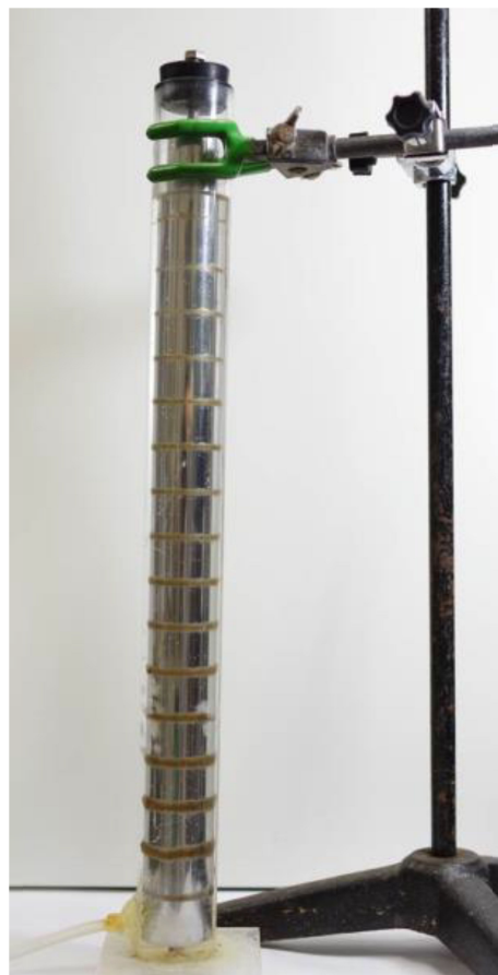
図 2 磁気分離カラムとマグネットバーに磁力で付着した濃縮汚泥
