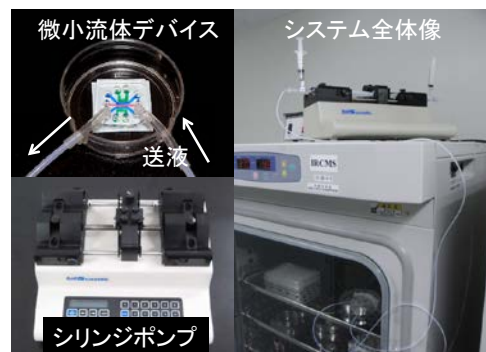
図2: 微小流体デバイス上の血管網への送液システム
