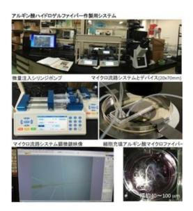
図に示すごとく、微量注入ポンプから各溶液が流入するマイクロ流路を倒立顕微鏡上におき、細胞懸濁液のアルギン酸がゲル化していく状況を随時リアルタイムで観察(下左)しながらマイクロファイバー型肝オルガノイドを作製するシステムを構築した。具体的には、ヒュージョンタッチ100 およびヒュージョンタッチ200(アイシス社製)の微量注入シリンジポンプを用いて、バッファー溶液・細胞懸濁液・ゲル化溶液をシリンジから倒立顕微鏡状に固定したマイクロ流路デバイス(中右)に任意の流速で注入するシステムを構築し
