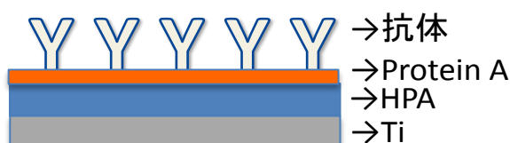
図 1 抗体を結合したチタン電極の断面構造
