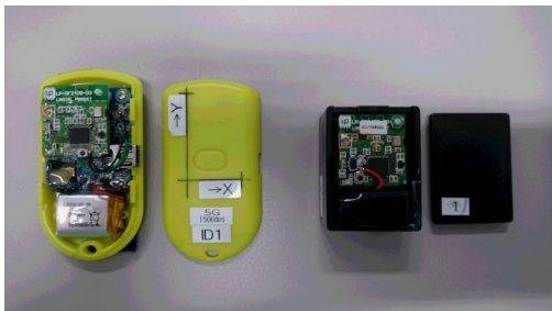
図1：新型（24ビット分解能ADコンバータ使用、スポーツセンシング社・特注品）（左）と旧型（16ビット分解能ADコンバータ使用）（右、スポーツセンシング社・WS1104）の慣性センサー
