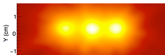
(図 4) ^{111}\text{In} 液体線源を用いて、3 つの点線源ファントム(150 kBq, 10 \mu\text{L} )を作り、コンプトンカメラ実験プラットフォーム(図 3)で取得したデータから再構成した画像。単純なバックプロジェクション法を用いて、3 線源を分解することができた。良質のデータが取得できていることを示す。
