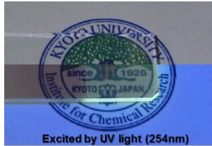
図2 作成したSnをドープした蛍光体薄膜の写真(下部は紫外線(254nm)照射時)
