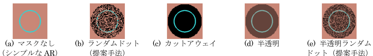
図 1 実験で用いたマスクの種類。被験者は nVidia 3D vision glass によって肌色面 (実物体を模擬) の背後にある青い円 (仮想物体) を観察する
