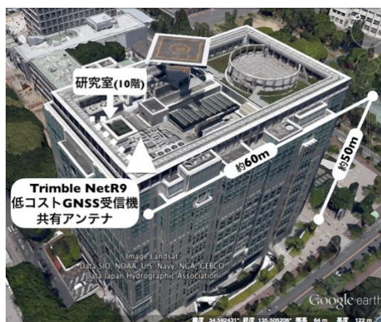
図1 観測用実験サイトでの機器の配置 (△はGNSSアンテナの位置を示す)
