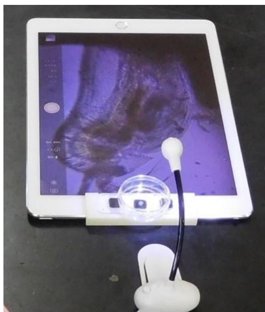
図2 顕微鏡レンズプレート (Leye) をタブレットに装着し観察する様子
