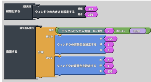
図6 タクトスイッチと描画を連携させる
