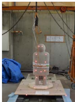
写真 4 計測マーカー設置状況 (左)
