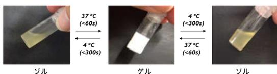
図2 キトサン誘導体水溶液を用いた場合の迅速なゾルゲル転移挙動
