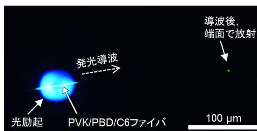
図 4. PVK/PBD/C6 ナノファイバーの胴部に励起光を照射したときの暗視野像. 光励起された位置での C6 の発光が, 同ファイバー中を導波し端面で放射されていることが分かる.
